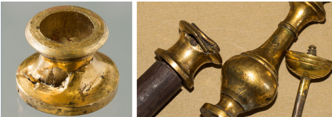
[fig. 31] Peças em liga de cobre com defeitos de fabrico (EX11 e EM5).
